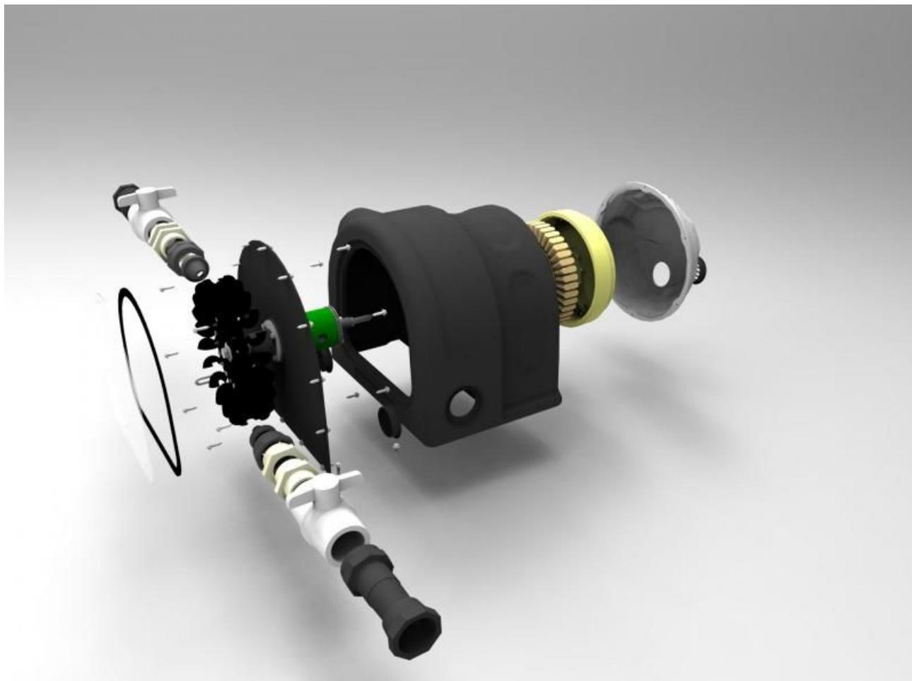
Microturbina idroelettrica da 1200Watt (1,2kw) con pale in plastica, rotore portapale in acciaio inox, generatore sincrono trifase con magnete permanente, due getti statici fissi. Questa microturbina idroelettrica di tipo Pelton è stata progettata per poter essere collegata a regolatori MMPT o ad inverter sia collegati alla rete che isolati dalla rete, è disponibile anche con interfaccia di sicurezza contro i sovraccarichi proteggendo regolatori ed inverter da eventuali danneggiamenti .
