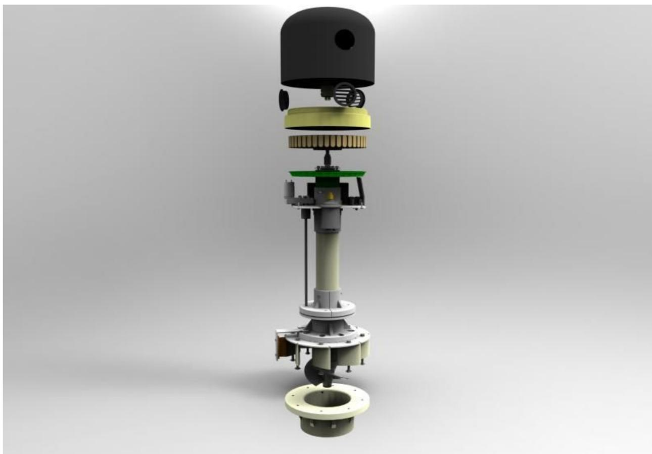
Micro turbina idroelettrica modello Kaplan (LH) disponibile con e senza con pulitore automatico, in grado di produrre energia elettrica con un minimo di 25 litri al secondo fino a 55 litri al secondo, questa micro turbina raggiunge il picco di produzione massima di 1500 watt a 880 giri al minuto.
